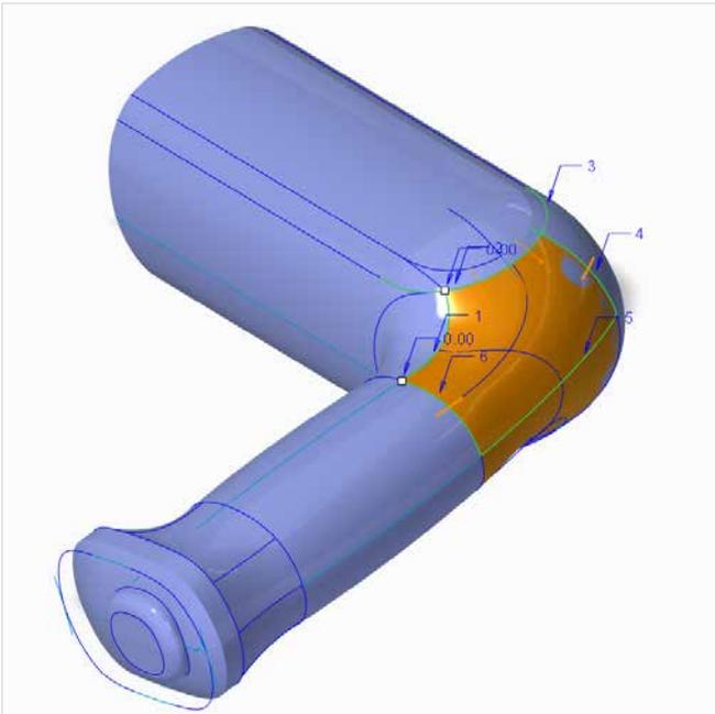
Erweiterte Flächenkonstruktionstools in PTC Creo ISDX ermöglichen die Erstellung von hochwertigen Oberflächen bei mehr als 4 vorhandenen Begrenzungen.
