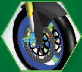
Statische strukturmehchanische Analyse
