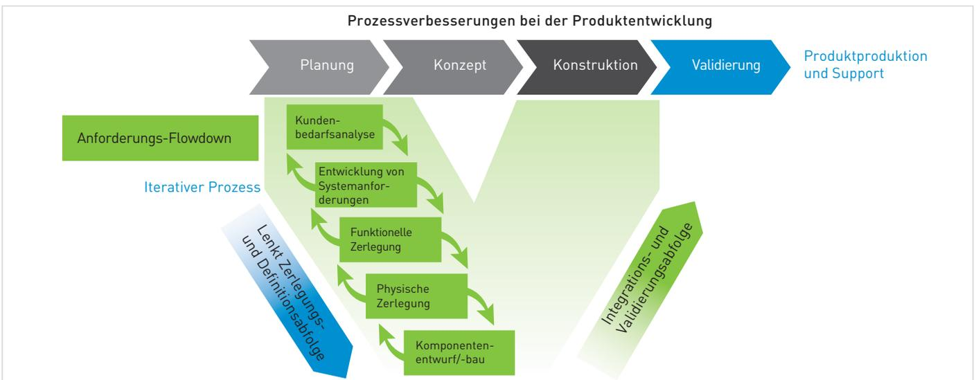
Abbildung 1: Anforderungs-Flowdown von anfänglichen Anforderungen bis zur Detailkonstruktion
